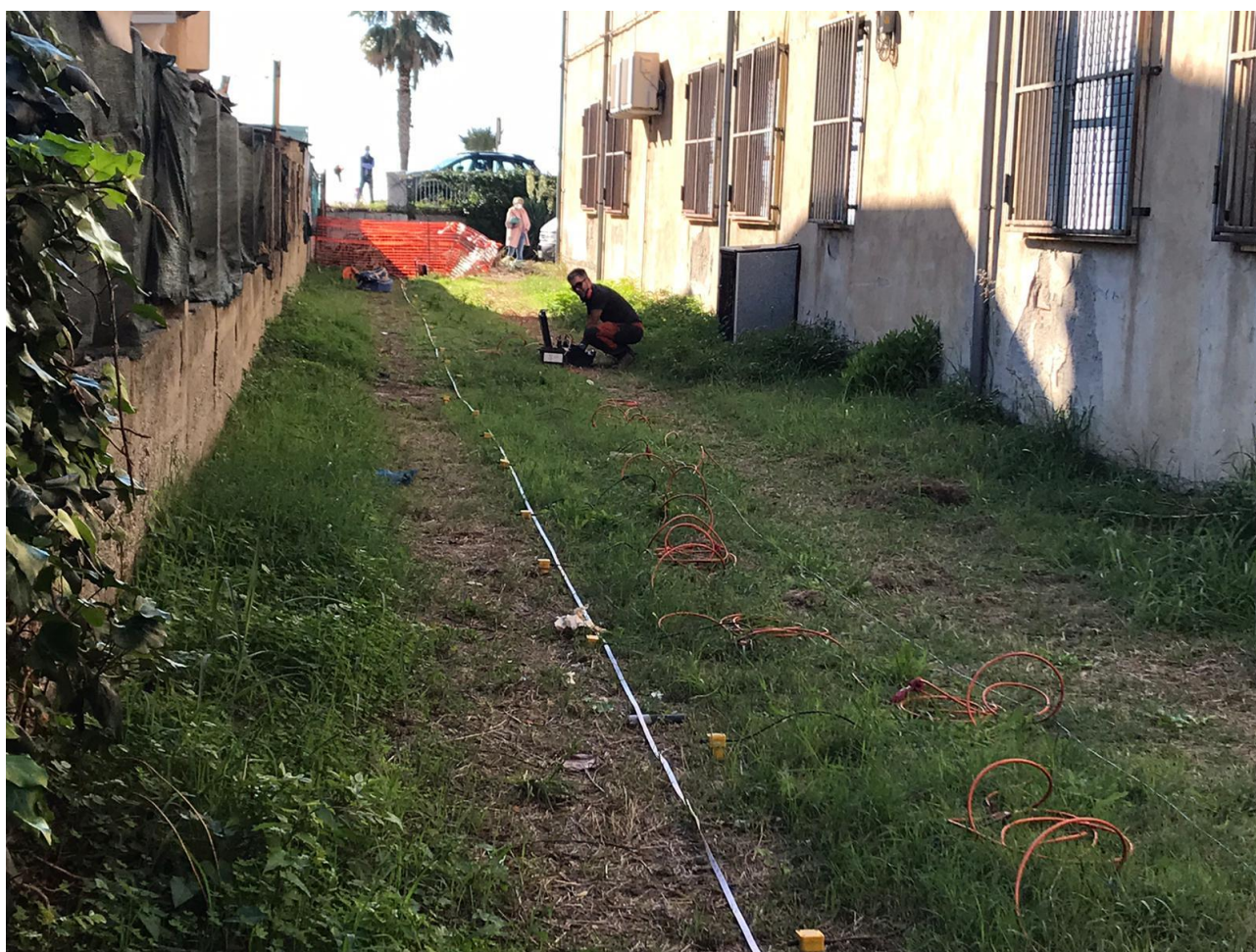
Foto n° 1: Ubicazione e stendimento prospezione geofisica in modalità Masw e rifrazione Gizzzeria.
